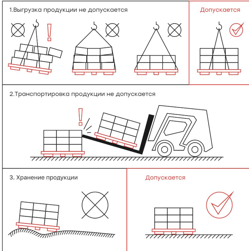
Для исключения повреждения изделий в процессе погрузочно-разгрузочных работ и хранения рекомендуется соблюдать общие требования к данным видам работ. Погрузку, транспортирование, разгрузку и хранение изделий следует проводить с соблюдением мер, исключающих возможность их повреждения.
